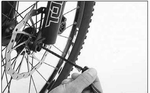
2. Setzen Sie die Feder und die Schraubenmutter auf die Achse. Drehen Sie auf das rechte Ende, das jetzt aus der Nabe heraussteht, die Schraubenmutter im Uhrzeigersinn.
