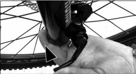
3. Achten Sie auf einen festen Sitz und die geeignete Positionierung des Spannhebels. Bitte entnehmen Sie die korrekte Positionierung und deren Einstellung der Bedienungsanleitung des jeweiligen Schnellspanner-Steckachsen Herstellers.
