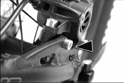
**Verschraubung, nicht korrekt** Eine lockere Schraube ist oft durch einen abstehenden Schraubenkopf erkennbar.
