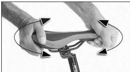
Versuchen Sie den Sattel durch entgegengesetzte Auf- und Abbewegungen mit Handkraft in seiner Klemmung zu bewegen.
