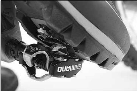
c) Wenn sich die Hakenspitze an der richtigen Position im Pedal befindet, treten Sie mit einem kräftigen Ruck mit der gesamten Fußfläche nach unten, bis der Klemmmechanismus deutlich hörbar einrastet.
