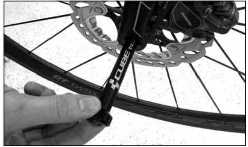
2. Befestigen Sie die Steckachse handfest mit einem Inbusschlüssel.
