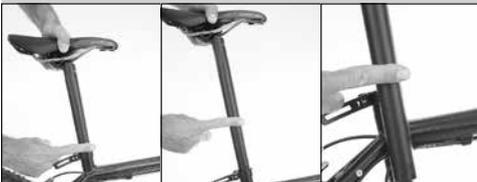
3. **Drehen Sie den Sattel so, dass die Sattelspitze in Fahrtrichtung zeigt.**
