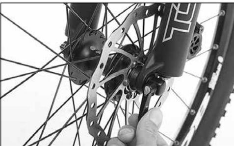
2. Drehen Sie die Schraubenmutter soweit gegen den Uhrzeigersinn bis sich das Laufrad ohne großen Kraftaufwand aus dem Rahmen bzw. aus der Vorderradgabel nehmen lässt.
