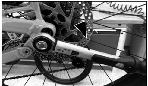
4. Für den Ausbau müssen sie die Steckachse mit einem Inbusschlüssel heraus-schrauben.
