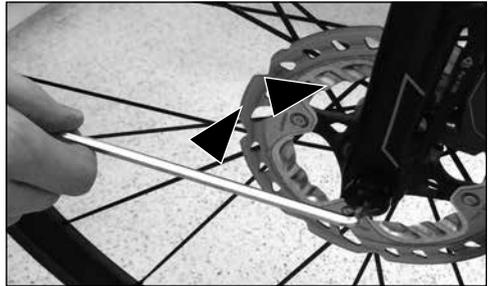
3. Anschließend fixieren Sie die Steckachse nach den Vorgaben des Herstellers mit einem Drehmomentschlüssel.
