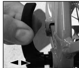
3. Durch loslassen des RWS-Spannhebels rastet dieser dann an der gewünschten Position sicher ein. Achten Sie auf einen festen Sitz und die geeignete Positionierung des Spannhebels. Bitte entnehmen Sie die korrekte Positionierung und deren Einstellung der Bedienungsanleitung des jeweiligen Schnellspanner-Steckachsen Herstellers.
