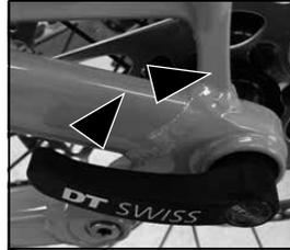
2. Die minimal anzuwendende Handkraft beträgt 15 Nm. Der RWS-Spannhebel kann danach durch leichtes Herausziehen des Hebels in einer günstigen Position arretiert werden.
