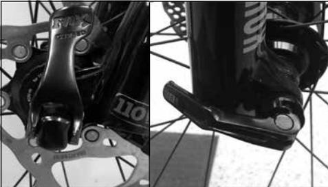
4. Für den Ausbau müssen Sie den Schnellspanner der Achse öffnen. Nachdem dieser geöffnet ist, kann die Steckachse herausgeschraubt und komplett aus der Nabe entnommen werden.
